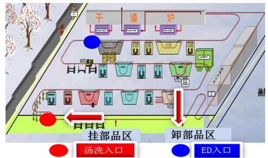
涂装工序主要为:汤洗→预脱脂→NO.1水洗→NO.2水洗→NO.3水洗→表调→化成→NO.4水洗→NO.5水洗→纯洗→NO.6水洗→新纯水→ED→UF1水洗→UF2水洗→UF3水洗→UF4水洗→UF5水洗→新纯水→干燥。
